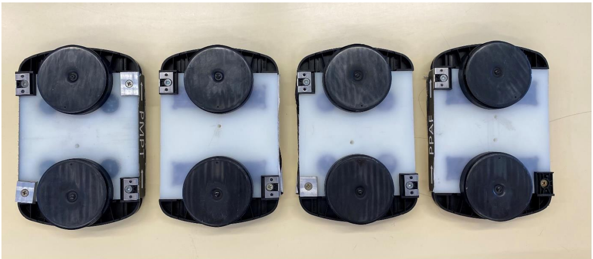
Figura 17 - Disposição das chapas metálicas nas paletes
