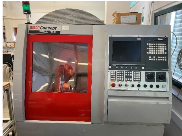
Figura 3 - Fresadora EMCO Concept MILL 155
