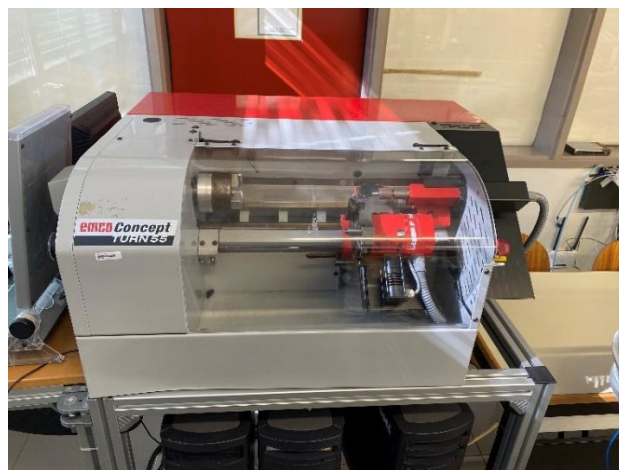
Figura 4 - Torno EMCO Concept TURN 55
