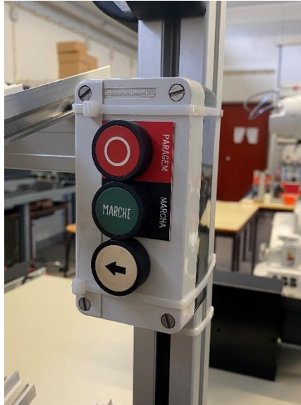
Figura 52 - Botoneira para executar a marcha e paragem
